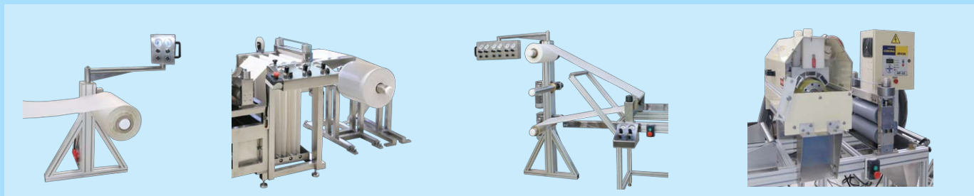
desarrollador con freno y pinza para fijar/soltar rolo
