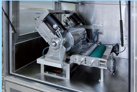
accionamiento principal seguido de unidad para aplicación de líquido por derramamiento
