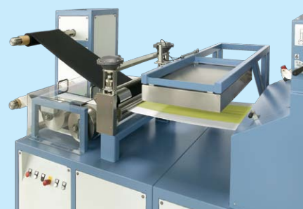
secadora infrarroja, rolos de enfriamiento y arolladores
