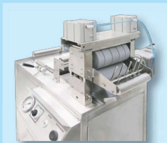
cilindro del foulard con canal / rebajo para guiar cintas de cierre
