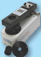
FX 3340 Miniair - portátil compacto Testes de Permeabilidade al Aire
