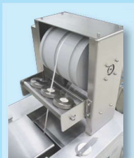
membranas „raspadoras” (que son cambiadas de acuerdo con el diámetro de las cuerdas)
