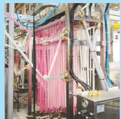
dos tipos de cintas, cada una con un color diferente en la lavadora doble
