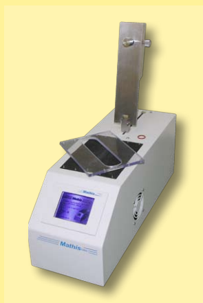
crockmeter con papel abrasivo y soporte de acrílico
