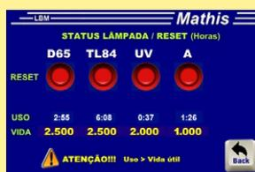
Controlador IHM touch screen con contador de horas para el control individual del número de horas prendidas de cada una de las lámparas, para garantizar la calidad de la distribución de energía espectral.
