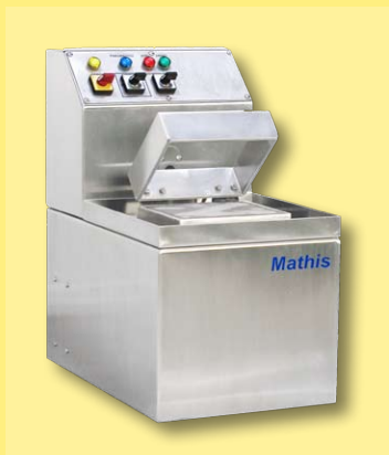
Formador de Hojas de Papel equipo para la formación de hojas de papel (15 cm x 18 cm) a partir de masa de celulosa en agua modelo FORM-B
