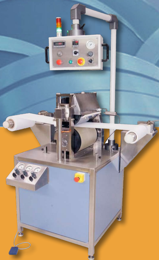
Calandria para el acabado por medio de presión y calor de superficie modelo CAL-S-B
