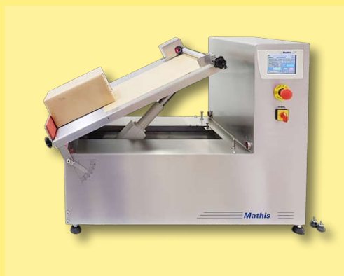
Equipo con rampa para deslizamiento usado para Testes de Productos Antiderrapantes modelo PAP-B
