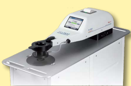
Equipo para ensayos de permeabilidad al aire modelo FX-3300 IV Textest AG
