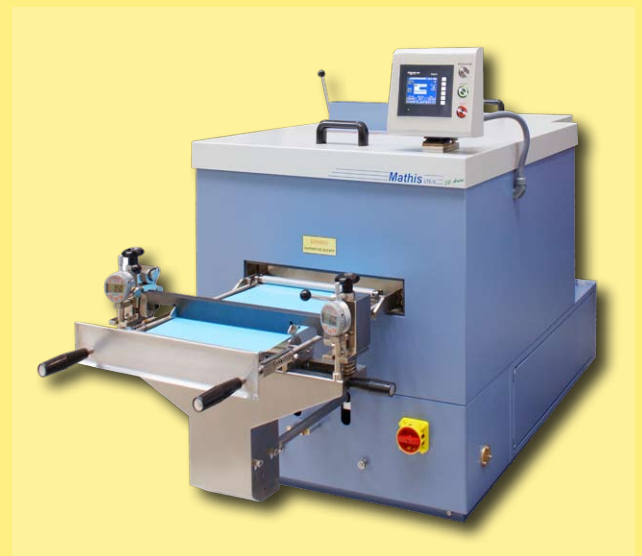
Rama secadora de aire caliente con cabeza de revestimiento coating acoplado modelo LTE-S-B
