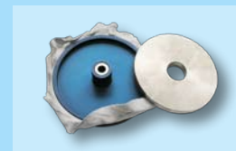
soporte de pruebas ISO 12945-2 y peso 260g
