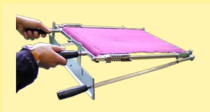
Cuadro de agujas para aplicaciones frente-verso: cuadro dentro de cuadro, que permite el revestimiento en la superficie de arriba (frente), seguida de aplicación en la superficie debajo (verso) de la muestra. Usado en conjunto con aplicador tipo coating modelo SV de Mathis.
