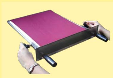
Cuadro de agujas con ajuste de largo: la muestra es fija en las agujas del inicio y fin del cuadro, y estirada con tensión de 0 hasta 10 kP.
