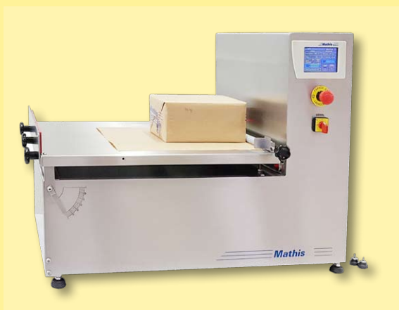
Ensayo de deslizamiento para evaluar a los productos antideslizantes
