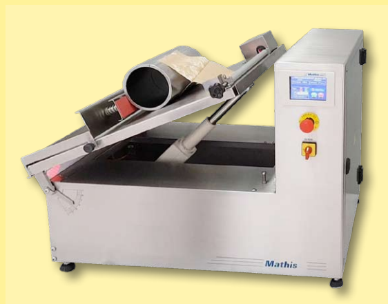
Opcional: teste de desgarre / deslaminado con ayuda de cilindro de 3,5 kg
