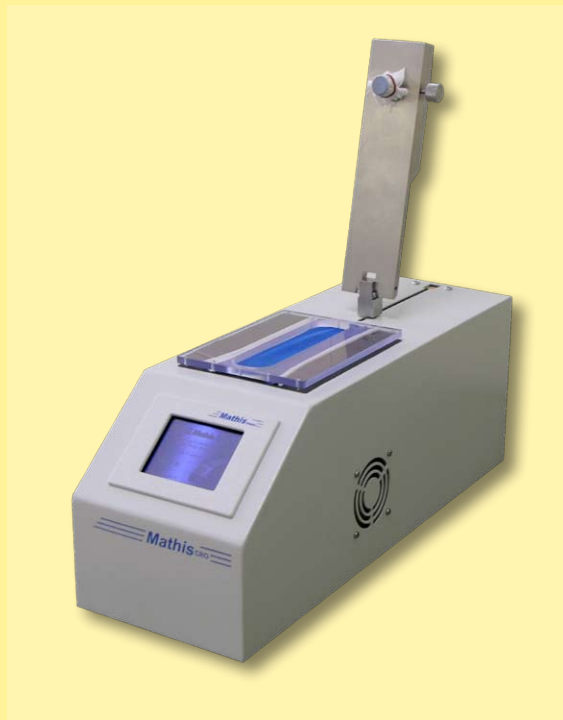
crockmeter com amostra e testemunha
