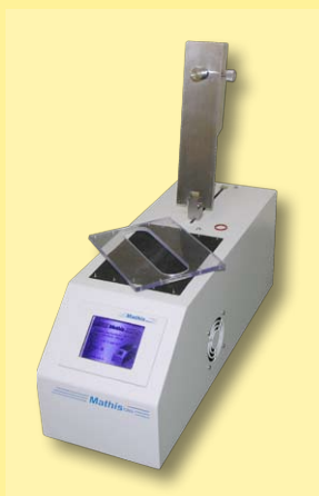
crockmeter com papel lixa e suporte de acrílico
