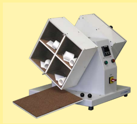
caixas com 4 compartimentos de 11cm x 11cm x 11cm cada conforme especificações Clariant
