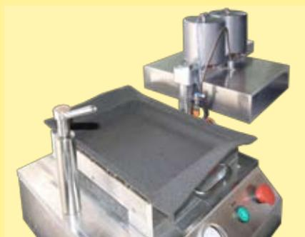
prensa com amostra de carpete conformada em molde
