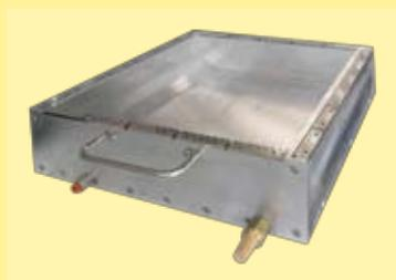
base com molde de conformação (e conexão de ar comprimido para sistema de refrigeração da amostra)
