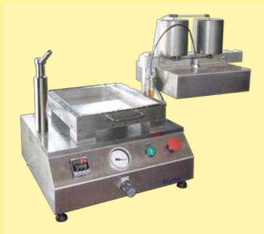
prensa de conformação com base de molde aberta
