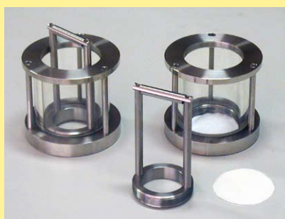
vasos de vidrio con soportes para fijar a las pruebas de papel en ensayo con líquidos
