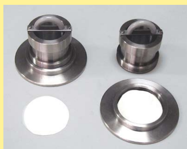
soporte removible para fijar a la prueba de papel en ensayo con grasas y aceite (El soporte está apenas apoyado sobre el vidrio en la base.)
