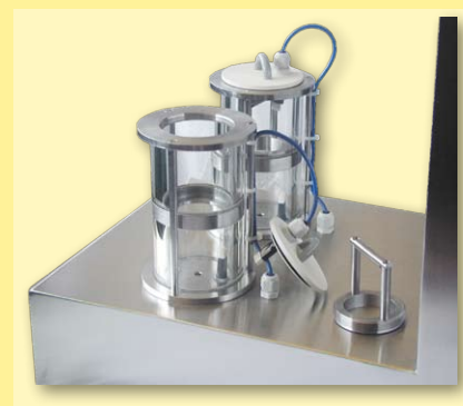
Vasos de vidrio con soporte de prueba de papel y tapa con electrodo de humedad
