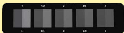
escala de grises - norma ISO 105 A02 para evaluar el cambio de color (pérdida de color)
