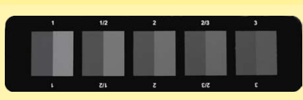
escala de cinzas - norma ISO 105 A02 para avaliação de alteração de cor (desbote)
