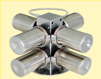
Disco com 8 canecas de 500ml para solidez à lavagem
