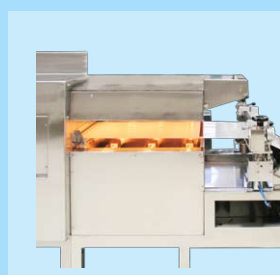
pré-aquecimento infra-vermelho superior e/ou inferior
