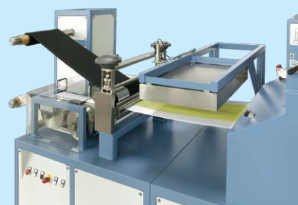
secador infra-vermelho, rolos de resfriamento e enroladores
