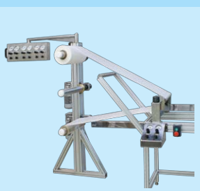
enrolador(es) e sistema de laminação (dublagem)
