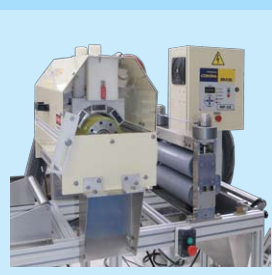
unidade Corona para preparação de superfície com descargas elétricas
