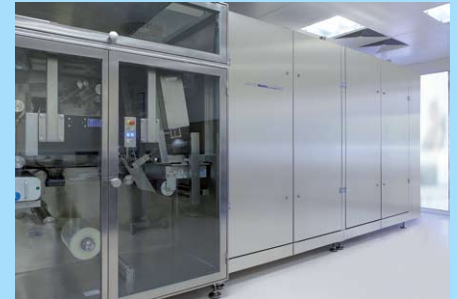
secador compacto de quatro zonas
