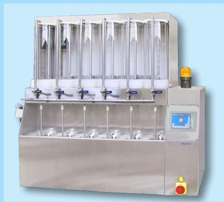
Permite ainda comandos de acionamento manual como agitação dos recipientes de vidro e dos tanques de aço inoxidável, assim como alimentação dos tanques com transbordo para enxágües, além de dreno. Ducha para auxiliar na limpeza.
