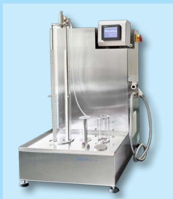
Possui microprocessador Touch Screen com display gráfico que faz todo o controle automático de processo com programação de: controle de velocidade da bomba de circulação, gradientes de aquecimento, resfriamento, patamares e alarmes.
