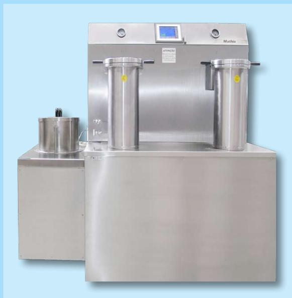
**TINGIMENTO DE FITAS, TECIDOS E FIOS EM AUTOCLAVE ATÉ 130°C - TIPO TURBO****Máquina para Tingimento de até 15 kg**
