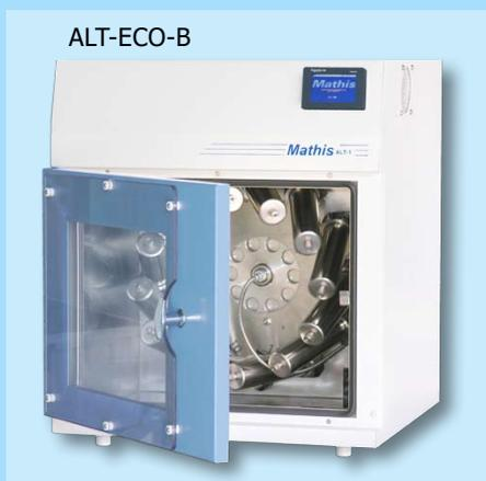
A versão ALT-ECO possui microprocessador touch screen mais simples para o acompanhamento e controle automático de processo, com programação de movimento de autoreversão e velocidade de rotação do disco com as canecas, gradientes de aquecimento e resfriamento, patamares, alarmes.
