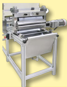
tina de imersão com foulard espremedor de impregnação e transporte
