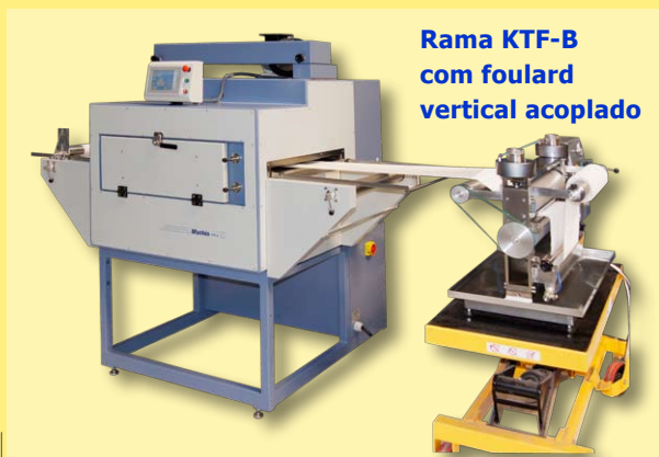
desenrolador com freio e pinça para fixar/soltar rolo
