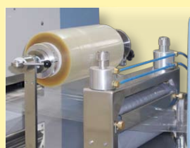
foulard para laminação (dublagem)
