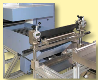
cabeçote de revestimento coating com faca raspadora e ajuste micrométrico de espessura
