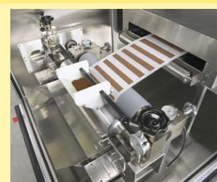
coating com faca e sistema adicional de rolos para aplicação de revestimento em tiras
