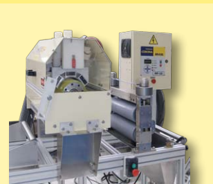
unidade Corona para preparação de superfície com descargas elétricas (unidade de terceiros)
