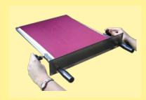
Armação de agulhas com ajuste de comprimento: a amostra é presa nas agulhas do início e fim do quadro, e esticada com tensão de 0 a 10 kP.
